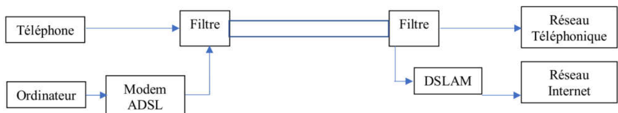
Figure III.4 : Liaison ADSL entre un utilisateur final et des réseaux voix et data.
